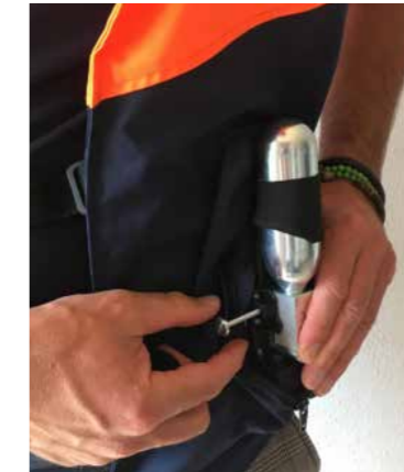
Sicherungsstift reinschieben und Flexband und Gasflasche legen.
